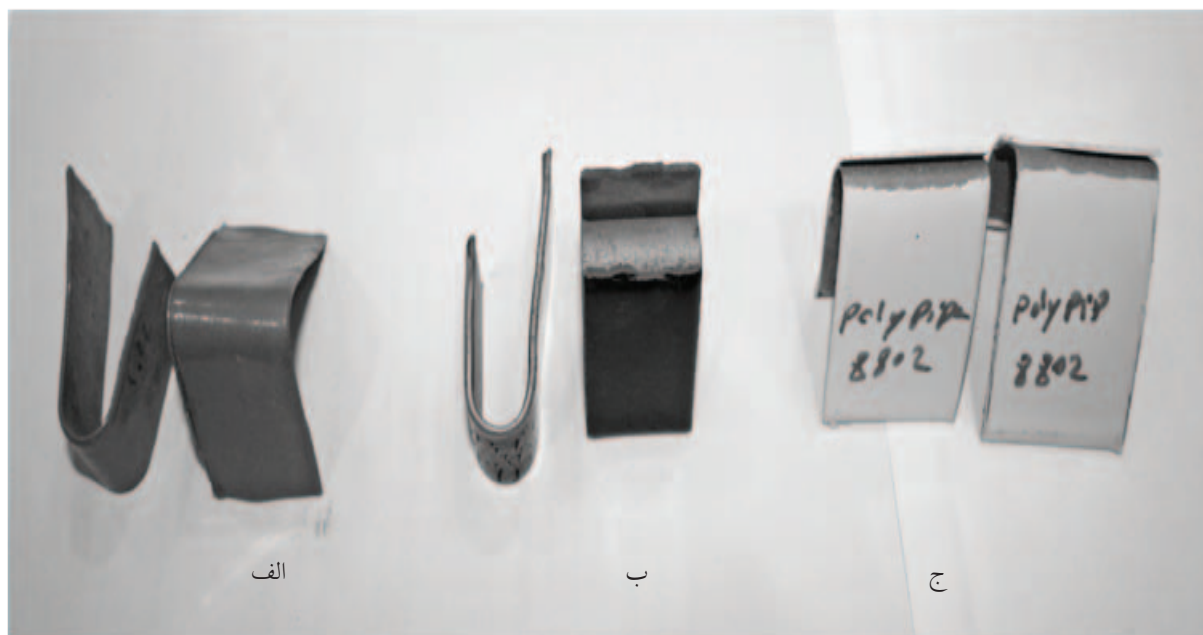
شکل ۴- نمونه‌هایی از پوشش‌های تحت بررسی پس از آزمون مقاومت خمشی: الف- پلی اوره ب- پلی یورتان ۲ و ج- پلی یورتان ۱
