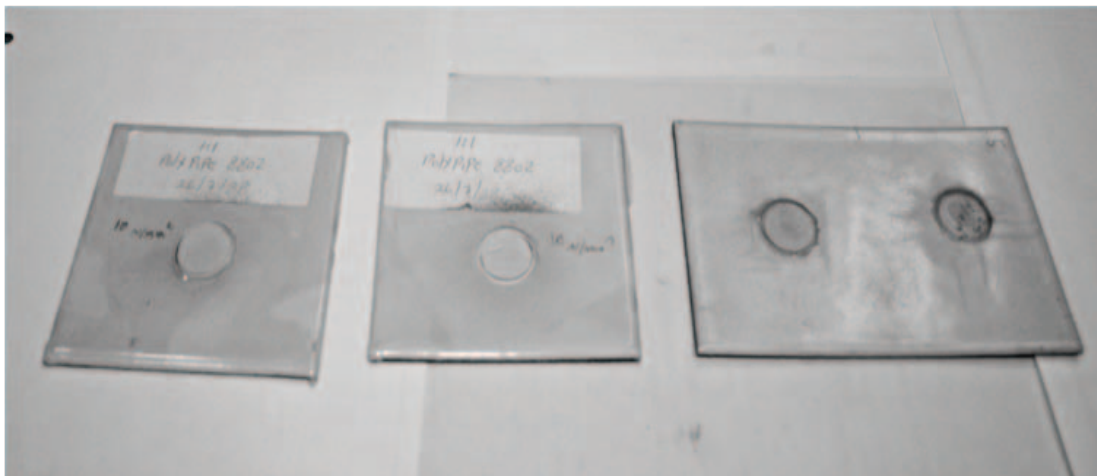
شکل ۱- نمونه‌های پوشش پلی یورتان ۱ پس از آزمون چسبندگی (رنگ سفید داخل حفره‌ها نشانه باقی ماندن پوشش روی سطح است)
