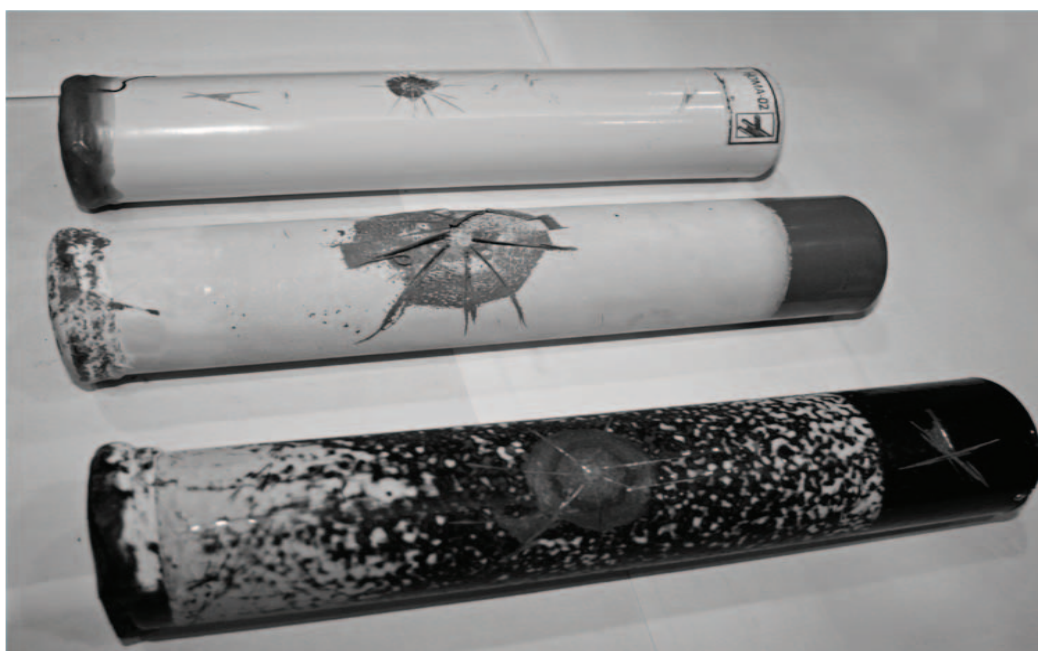
شکل ۶- نمونه‌های پوشش پس از آزمون گسیختگی کاتدی: (پلی‌یورتان ۲ مشکی، پایین صفحه)، پلی‌اوره (طوسی، وسط) و پلی‌یورتان ۱ (سفید، بالای تصویر)
