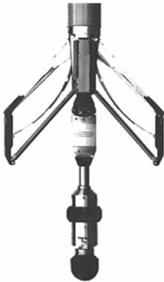
شکل ۱- دستگاه FMS دارای ۴ بالشتک بوده که در هر بالشتک ۱۶ دکمه وجود دارد [۵]
