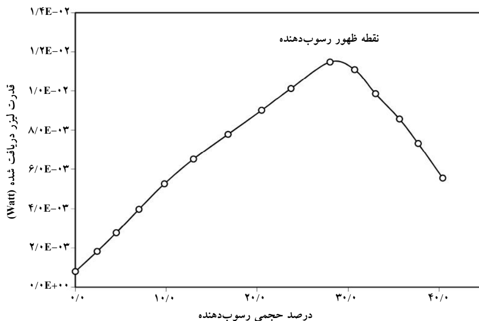
شکل ۲- شدت نور لیزر دریافتی بر حسب Watt در مقابل درصد حجمی رسوب‌دهنده در نفت معمولی A
