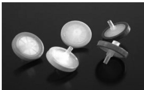
شکل ۱- فیلترهای سرنگی برای فیلتراسیون نمونه‌های نفتی محتوی ذرات جامد
