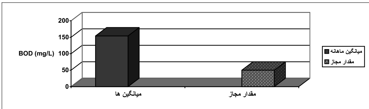
شکل ۱۴- مقایسه میزان اکسیژن خواهی زیستی پساب خروجی واحد پارازیلن با مقادیر مجاز
