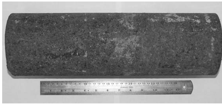
شکل ۳- نمای ظاهری از خوردگی حادث شده بر روی سطح خارجی نمونه لوله حفاری مورد بررسی
