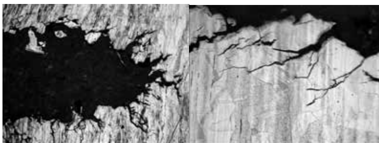
نمودار ۹- تصاویر میکروسکوپ نوری از نمونه پنجم ۳۱۶ کم کربن شکسته شده در کلرور منیزیم در دمای 154^{\circ}\text{C} و نرخ کرنش 10^{-6} \times 1/1 بر ثانیه، الف- بزرگنمایی ۱۰۰ برابر، و ب- بزرگنمایی ۲۰۰ برابر.
