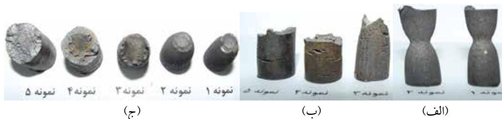
نمودار ۵- سطح شکست نمونه های ۳۱۶ آزمایش شده (الف) و (ب) نمای جانبی (ج)
