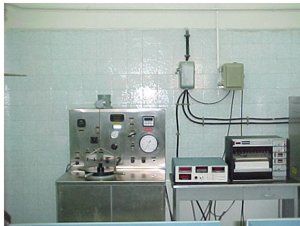
تصویر ۱- دستگاه مقاومت ژله ای استاتیکی (SGS)
