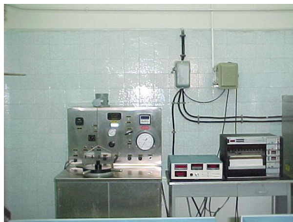
تصویر ۱- دستگاه مقاومت ژله ای استاتیکی (SGS)
