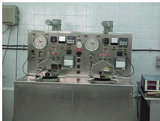
تصویر ۳- دستگاه اندازه‌گیری زمان نیم بندش سیمان (Consistometer)
