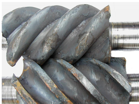
شکل ۴- آثار اکسیداسیون شدید در سطح روتور ها
