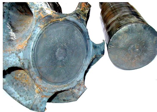
شکل ۳- تصویر وضعیت ظاهری روتورهای نر و ماده بعد از انهدام
