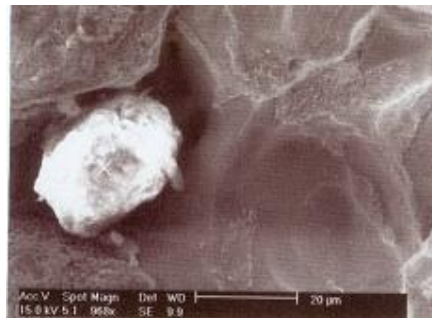
شکل ۱۱- تصاویر ناخالصی های موجود در سطح شکست توسط SEM
