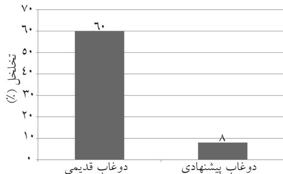
شکل ۵- تخلخل دوغاب قدیمی و دوغاب پیشنهادی
