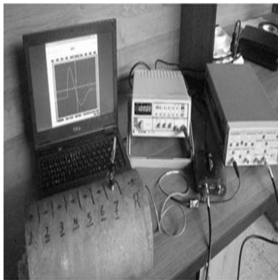
شکل ۵- سیستم و تجهیزات آزمون جریان گردابی گذرا
