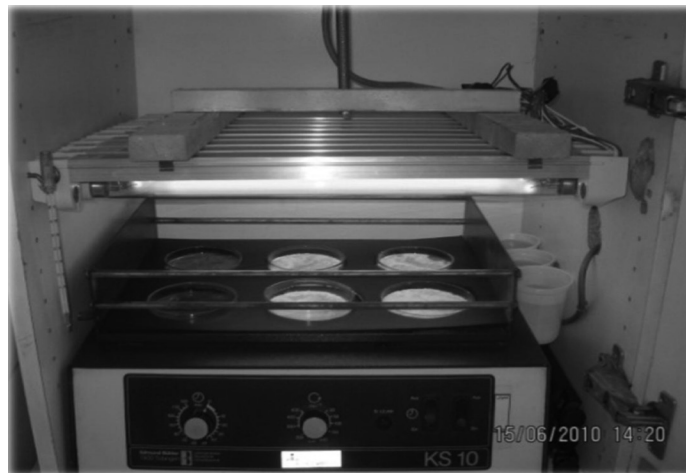
شکل ۲- کابینت تخریب مجهز به شیکر و منبع نور فرابنفش
