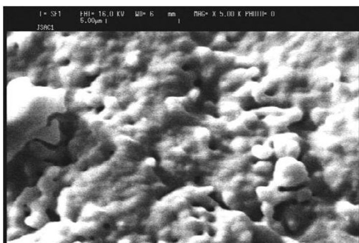
شکل ۶- SEM کاتالیست تهیه شده به روش هم‌رسوبی با بزرگنمایی ۵۰۰۰
