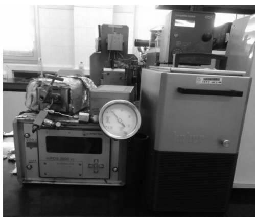
شکل ۲- دستگاه آزمایشگاهی DMA HPM برای اندازه‌گیری چگالی سیالات.
