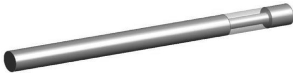
شکل ۲ دامنه محاسباتی برای شبیه‌سازی نیروی وارد بر پیگ.
