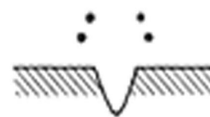
ث- حرکت جت آب با سرعت بسیار بالا شکل ۱- مراحل تشکیل و فروپاشی حباب
