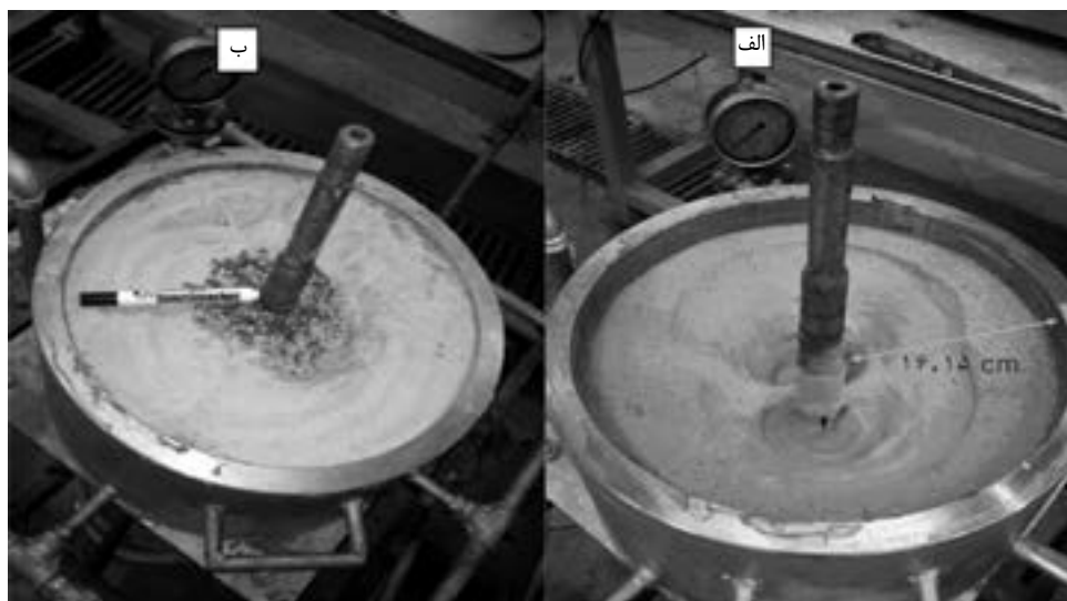
شکل ۴ الف) تصویر ماسه و گراول پک اطراف چاه و ب) تصویر عدسی‌های ایجاد شده در اطراف چاه بدون گراول.
