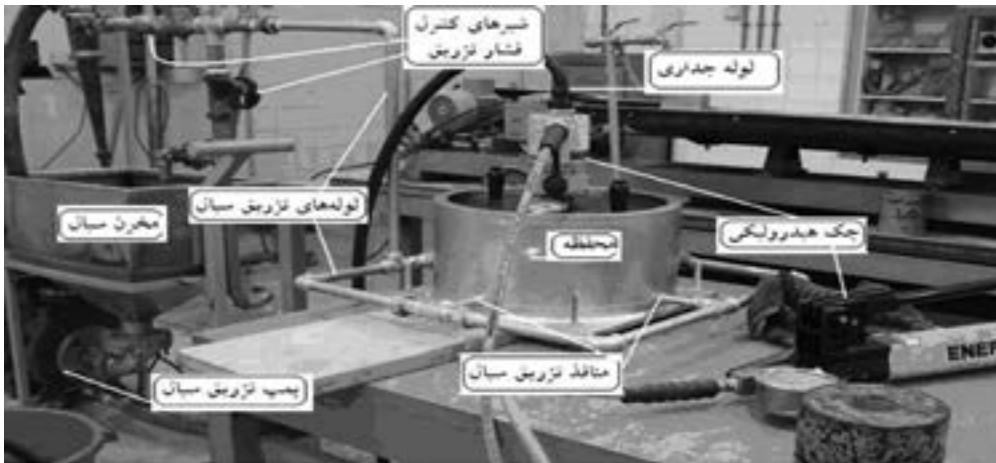
شکل ۲ تصویر دستگاه شبیه‌ساز مخزن.
