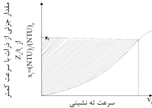
شکل ۷ راندنمان شماتیک حذف بر حسب سرعت ته نشینی
