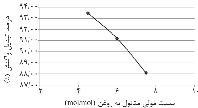
شکل ۱۱ تأثیر متوسط مولی متانول به روغن بر درصد تبدیل واکنش.
