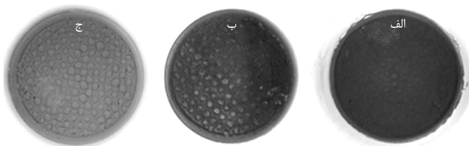
شکل ۴ تصویر نوری از (الف) غشای کامپوزیتی دینامیکی خود تشکیل یافته ، (ب) غشای کامپوزیتی دینامیکی از قبل پوشش داده شده و (ج) غشای پلیمری نگه دارنده بعد از فرآیند فیلتراسیون
