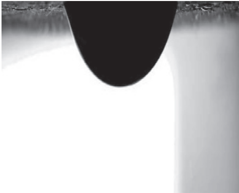
شکل ۲ آزمایش زاویه تماس بر روی قرص‌های سنگ برای تأیید نفت‌دوستی پس از مانس
