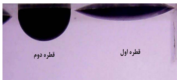
شکل ۸ مقایسه زاویه تماس قطره اول و دوم به ترتیب در حالت انتشار و همرفتی برای نانوسیال.
