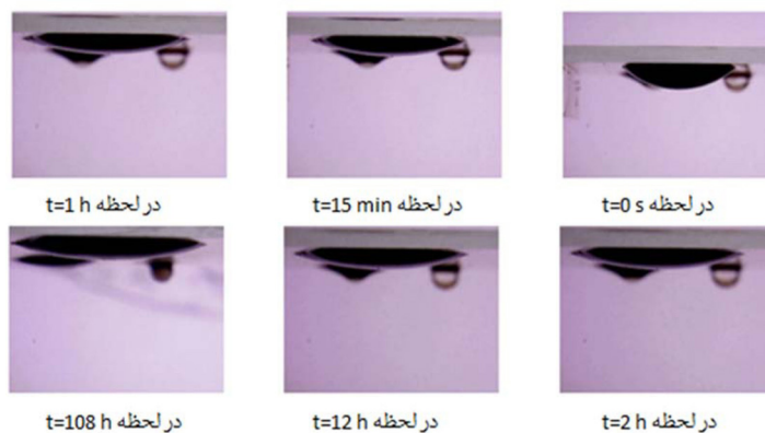
شکل ۱۰ عکس قطره نفت اول آزاد شده در ساعات مختلف در سیستم نفت خام/شیشه نفت دوست/محلول سورفکتانتی.
