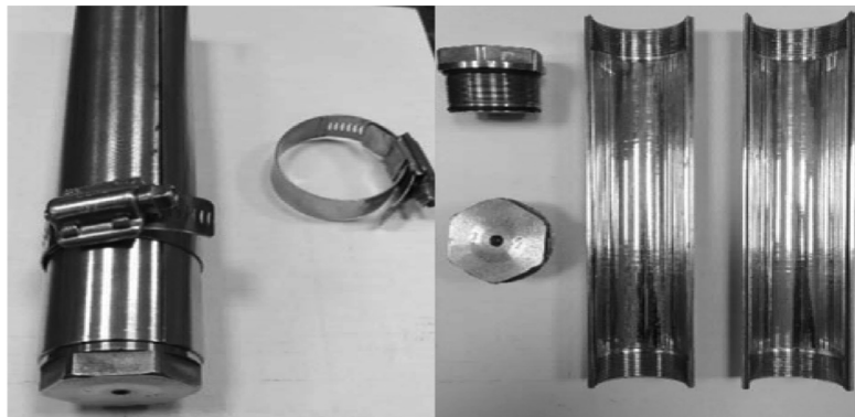
شکل ۳ محفظه فولادی مورد استفاده جهت تحکیم ماسه
