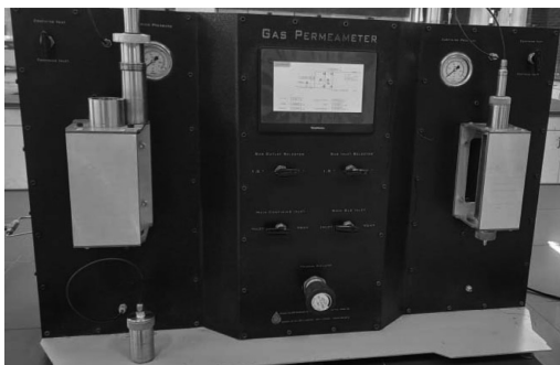
شکل ۵ دستگاه تراوانسج جهت اندازه‌گیری تراوایی
