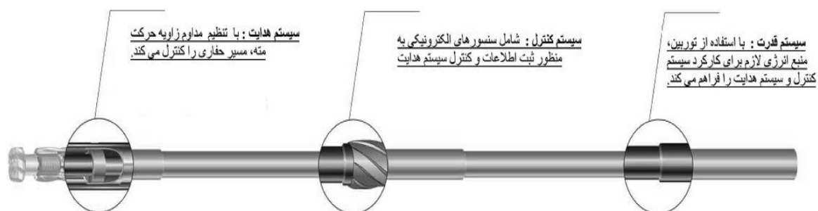
شکل ۲ بخش‌های مختلف سیستم دوار هدایت‌پذیر (RSS) [۶]
