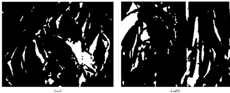
شکل ۵ برش دو بعدی از ریزساختارها: الف) تصویر واقعی گرفته شده با FIB-SEM و ب) تصویر ساخته شده با شبکه عصبی DCGAN
