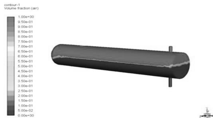
شکل ۳ کانتور کسر حجمی هوا در جداساز در حالت نیمه پر و فاصله ۹۰ cm بین خروجی و ورودی
