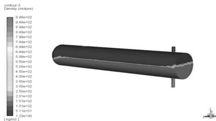
شکل ۴ کانتور چگالی مخلوط در جداساز در حالت نیمه پر و فاصله ۹۰ cm بین خروجی و ورودی
