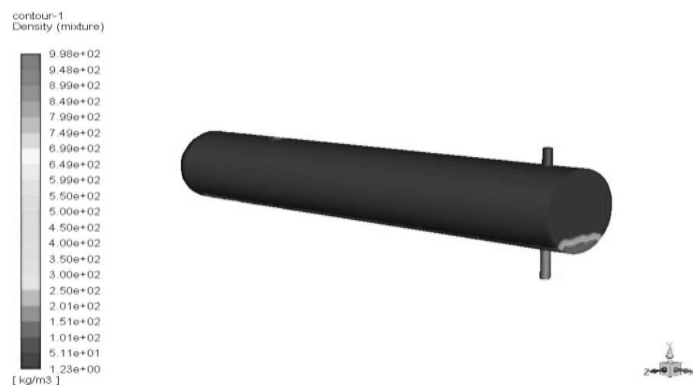
شکل ۷ کانتور چگالی مخلوط در جداساز با ارتفاع سطح مایع ۱۰٪ و فاصله ۹۰ cm بین خروجی و ورودی
