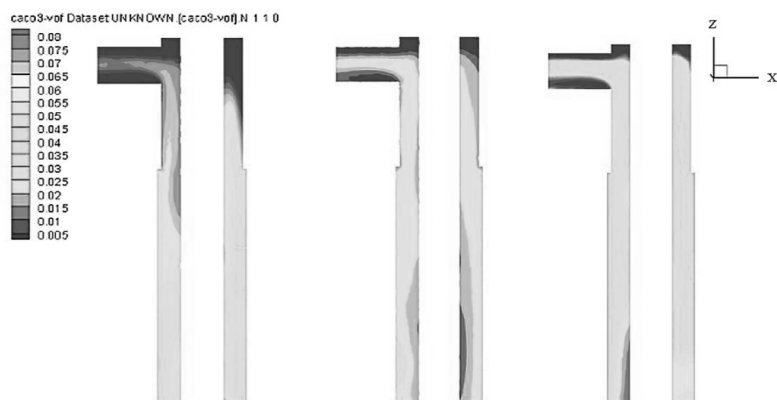
شکل ۱۰ مقایسه غلظت \text{CaCO}_3 باقی مانده در مدل و الگوی خروج آن به عنوان پایلوت در زمان t=8s در مش‌های مختلف نوع A، B و C (از راست به چپ)
