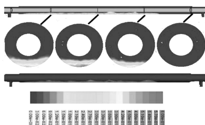
شکل ۱۳ نمودار مقدار \text{CaCO}_3 باقی مانده در سیستم در زمان t=30s برای مدل E2-475 [۱۹]
