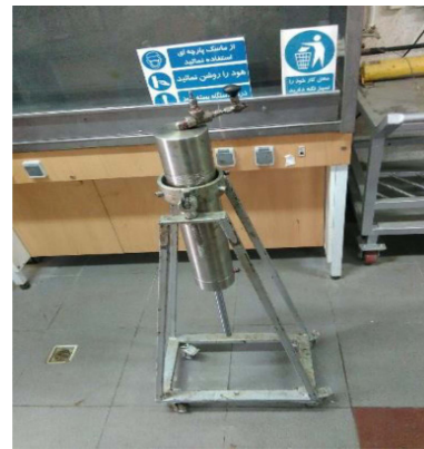
شکل ۷ انباشت‌گر جهت تزریق سیالات درون شن فشرده
