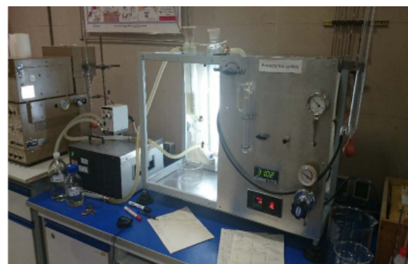
شکل ۴ سامانه اندازه‌گیری کف ساخته شده در آزمایشگاه
