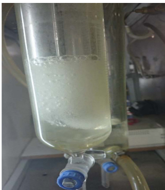
شکل ۵ عکس کف تشکیل شده در محلول ۰/۴۰ وزنی MDEA
