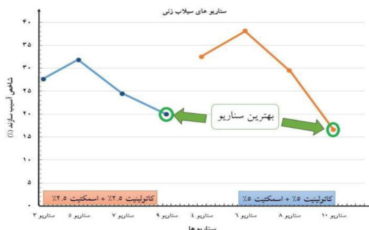
شکل ۲۰ تأثیر سناریوهای مختلف تزریق آب با شوری کم در میزان آسیب سازند در سیلاب زنی
