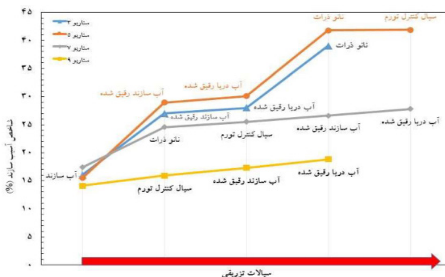
شکل ۱۸ مقایسه الگوهای تزریق در محیط متخلخل حاوی ۵٪ کائولینیت و اسمکتیت
