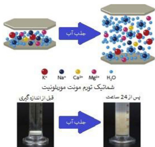
شکل ۱ روند تورم اسمکتیت در آزمایش شاخص تورم
