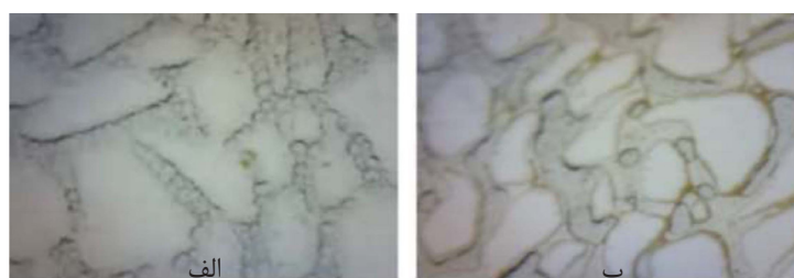
شکل ۲۳ تصویر مقیاس حفره از فوم CO_2 در (الف) وجود نانو (ب) عدم وجود نانو
