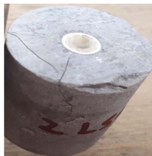
شکل ۵ نمونه کربناته خشک تحت تابش لیزر در داخل محفظه و تحت فشار.
