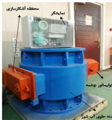
شکل ۵ نمایی از سیستم داده‌گیری تجربی، اندازه‌گیری چگالی محلول آب-نمک یدید سدیم موجود در آزمایشگاه
