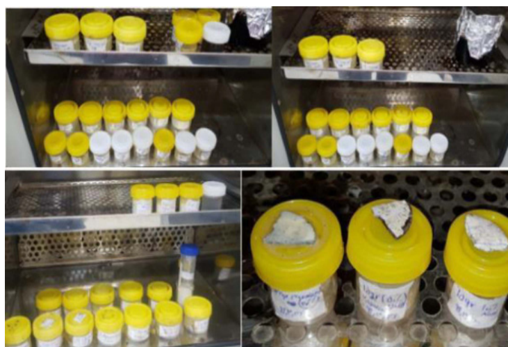
شکل ۲ تصاویر مربوط به پیرسازی مقاطع دایره‌ای سنگ مخزن کربناته در غلظت‌های wt % ۰/۰۵ تا ۰/۳۵ برای ۳ نوع نانو سیال حاوی نانو ذرات \text{Al}_2\text{O}_3 , \text{SiO}_2 , \text{TiO}_2
