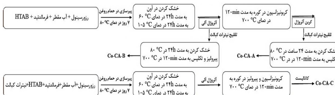
شکل ۲ طرحواره از نحوه نشان دادن جزء فعال کبالت بر روی پایه کربن آنروژل.
