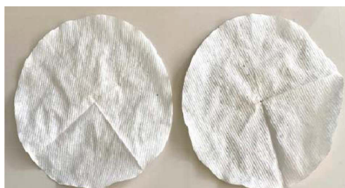
شکل ۱۸ سازگاری زه آب و پساب تولیدی همراه نفت (شکل راست الف) زه آب- ۱ (شکل ب) زه آب- ۲ (شکل چپ) کاغذ صافی بعد از عبور مخلوط زه آب- ۱ و ۲ و پساب
