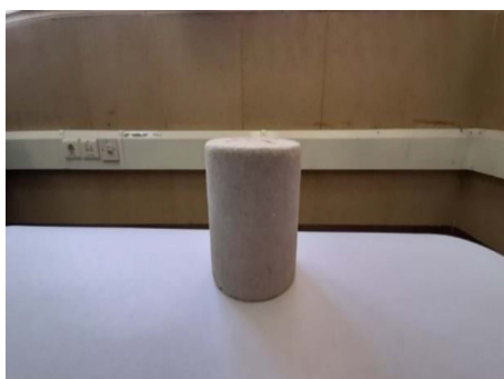
شکل ۱۱ نمونه مغزه تمیز پس از شستشو در ساکسوله جهت رفع آلودگی
