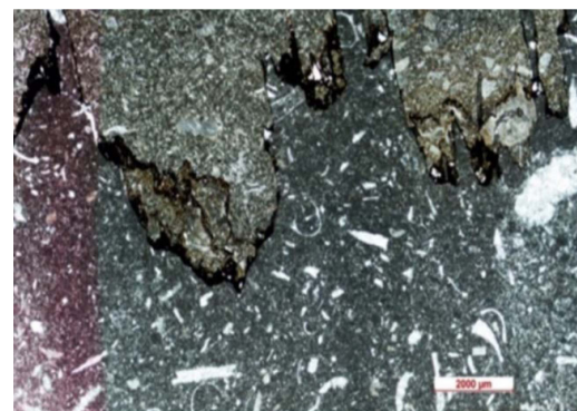
شکل ۸ مقطع نازک رخساره MF2 سازند سروک بالایی در عمق ۴۱۷۶/۲۶ m متر به همراه ندول‌های تبخیری
