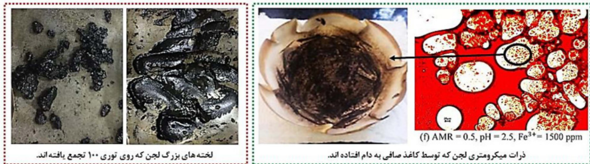
شکل ۶ ترسیب ذرات لجن اسیدی با مقادیر و اندازه متفاوت قابل عبور از توری [۲۸، ۳۰ و ۳۱]
