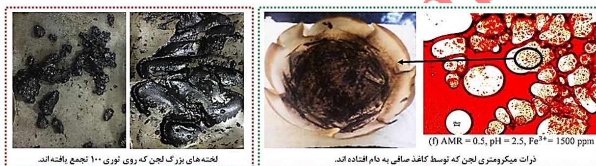
شکل ۶ - ترسیب ذرات لجن اسیدی با مقادیر و اندازه متفاوت قابل عبور از توری ۱۰۰ (Abbasi et al., 2023a; Kalthori et al., 2022; Mohammadzadeh-Shirazi et al., 2019)
