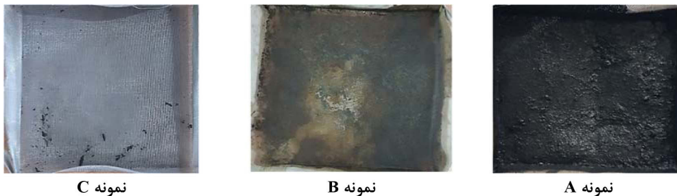
شکل ۶ تصویر لجن تشکیل شده در سه نمونه A، B و C در سرعت اختلاط ۱۵۰۰ rpm و دمای ۸۵ °C
