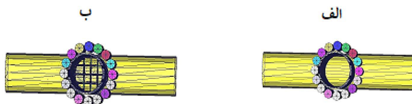
شکل ۵ نمای بالایی چیدمان نخست در دو حالت الف) با و ب) بدون حضور شبکه فلزی. طرح سه بعدی مدل از لوله و آشکارسازهای مستقر در زوایای مختلف پیرامونی.
