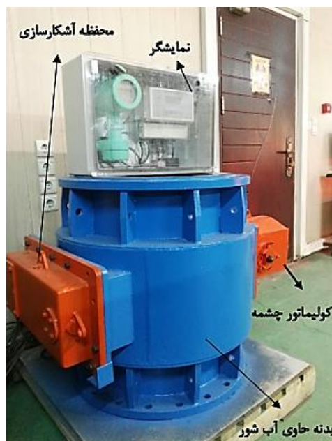
شکل ۸: نمایی از سیستم داده‌گیری تجربی، اندازه‌گیری چگالی محلول آب-نمک موجود در آزمایشگاه. سیستم غلظت‌سنج هسته‌ای مشتمل بر (۱) بدنه حاوی آب شور، (۲) محفظه آشکارسازی، (۳) یکسوساز چشمه، و (۴) جعبه حاوی صفحه نمایشگر.
