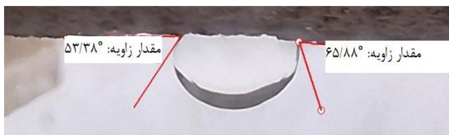
شکل ۲ نمونه‌ای از اندازه‌گیری زاویه تماس مقاطع نازک
