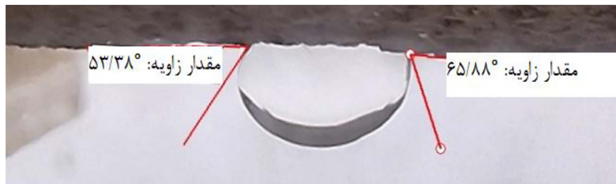
شکل ۲ نمونه‌ای از اندازه‌گیری زاویه تماس مقاطع نازک
