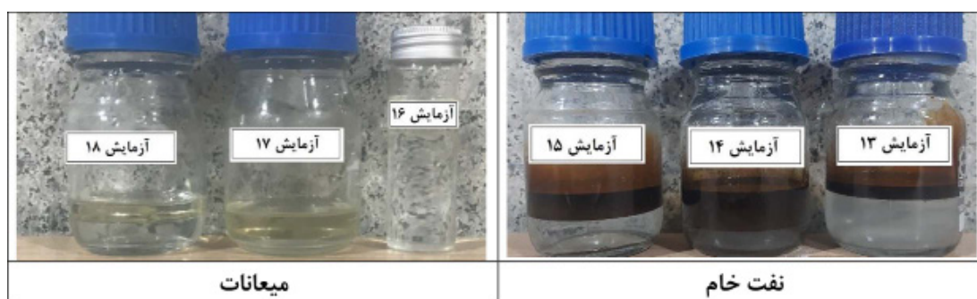
شکل ۶ سازگاری سیال پایه فسفاتی با میعانات و نفت خام
