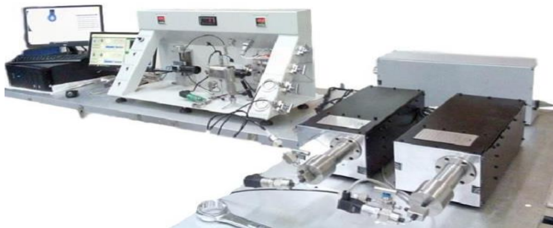
شکل ۱. دستگاه اندازه‌گیری کشش بین سطحی نفت و نانوسیالات با روش قطره آویزان
