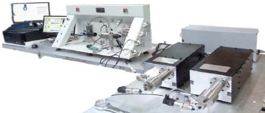
شکل ۱ دستگاه اندازه‌گیری کشش بین سطحی نفت و نانوسیالات با روش قطره‌آویزان
