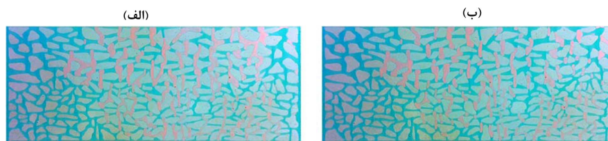
شکل ۳ تصاویر میکرومدل در طول تزریق آب با دبی: (الف) ۰/۰۰۲ mL/min، (ب) ۰/۰۲ mL/min
