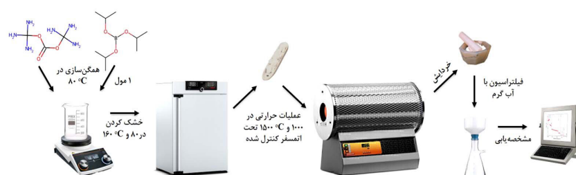
شکل ۱ طرحواره فرآیند سنتز و آنالیز نیتريدبور ساخته شده در دمای ^{\circ}\text{C} ۱۰۰۰ و ^{\circ}\text{C} ۱۵۰۰
